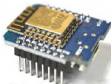
Qurilmaning asosiy qismi ESP8266 (D1 mini)
