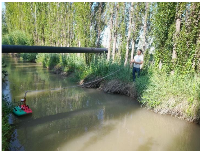
1-rasm. Dopler Soontek-RS5 (TBX) va Batometr o'lchov asboblari yordamida dala tadqiqotlari olib borilish jarayonlari [19,20]
