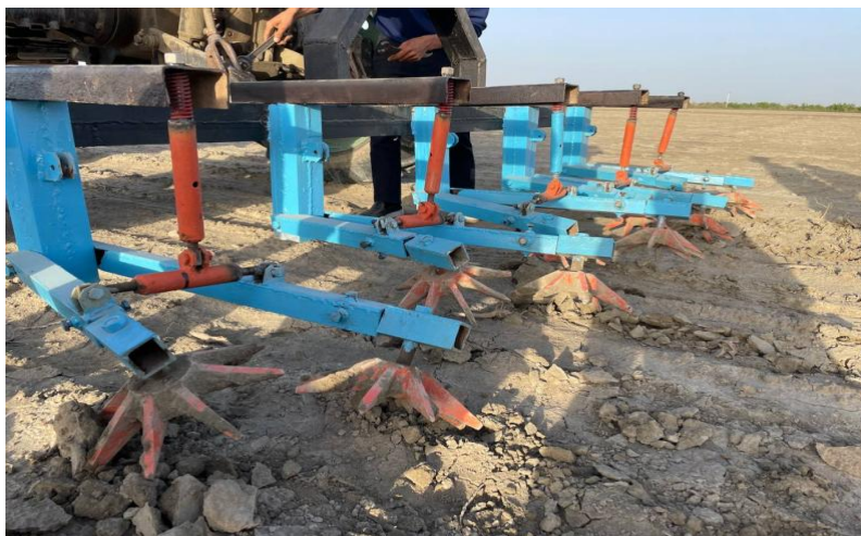
4-rasm. Qatqaloqni yumshatish qurilmasi ishchi organlarning ish jarayonida ko'rinishi.
