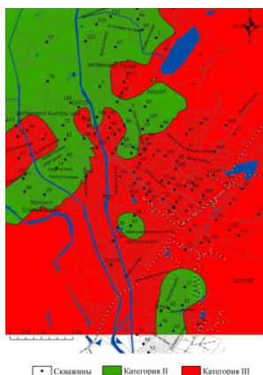
Рис. 7. Площадь распределения грунтов города Нукуса, залегающих на глубине 2,0 м по категориям сейсмических свойств.
